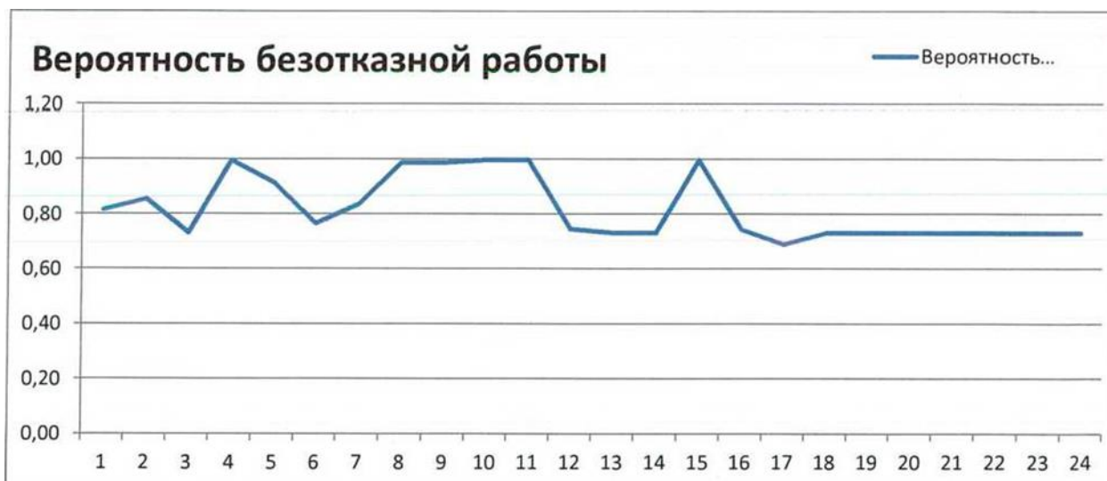
Рисунок 3.8-2 ВБР относительно ТК магистрального теплопровода ЦТЭЦ- ТК-41 по ул. Курако Центральный район (расчетный путь 8)
